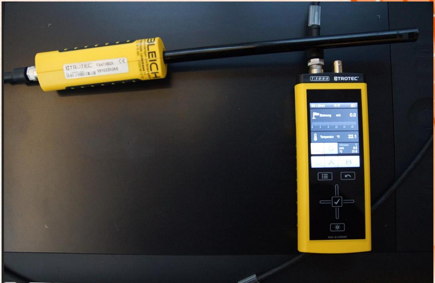
Mit diesem Sensor können gleichzeitig Luftströmungsgeschwindigkeit bzw. Luftvolumenstrom und -temperatur gemessen werden
